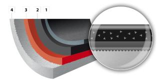
DURIT Dynamic ist ein universelles, dreischichtiges Antihaftsystem auf wässriger Basis. Durch die allgemein gute Performance wie Antihafteffekt, Abriebbeständigkeit und Korrosionsbeständigkeit ist das Produkt besonders für den täglichen Gebrauch gut geeignet.
