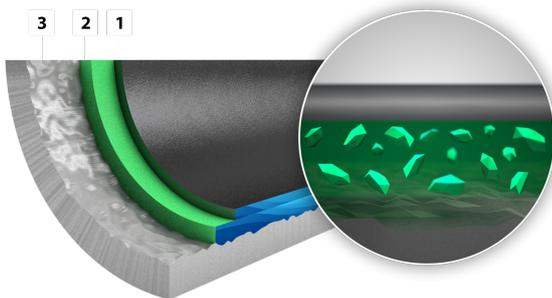
Ceralon ist ein ein- oder zweischichtiges System mit hoher Härte, welches eine sehr hohe Temperaturbeständigkeit mit guten Antihafteigenschaften und hervorragender Reinigungsfähigkeit kombiniert.
